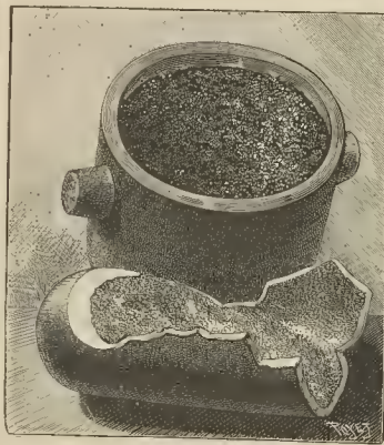
Fig. 1 Crisoles tapizados de rubíes artificiales
